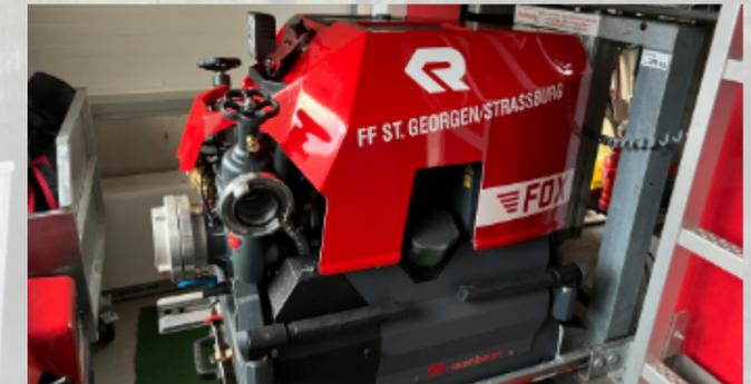
Die neue FOX 4 entspricht den neuesten Standards und bringt eine Pumpleistung von 1.650 Liter pro Minute bei 10 bar Druck. Bei geringeren Drücken sogar bis zu 2.250 l/min.
